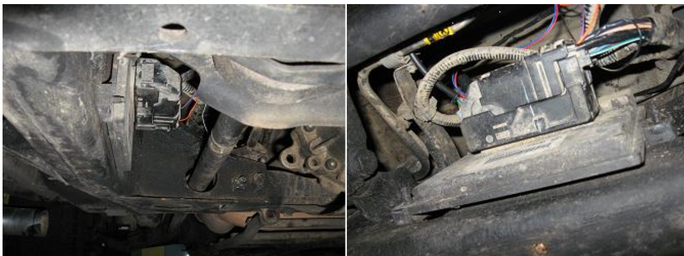
Rysunek 4 Umiejscowienie modułu pompy paliwowej
