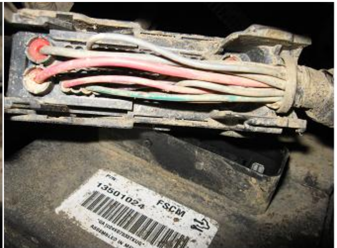
Rysunek 6 Widok złącza wiązki modułu FSCM
