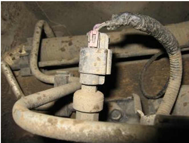
Rysunek 5 Widok czujnika ciśnienia paliwa
